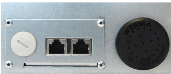
Im unteren Teil des Steuersystems sind die Konnektoren für die Datenverbindung RJ45 und die Alarmsirene platziert
